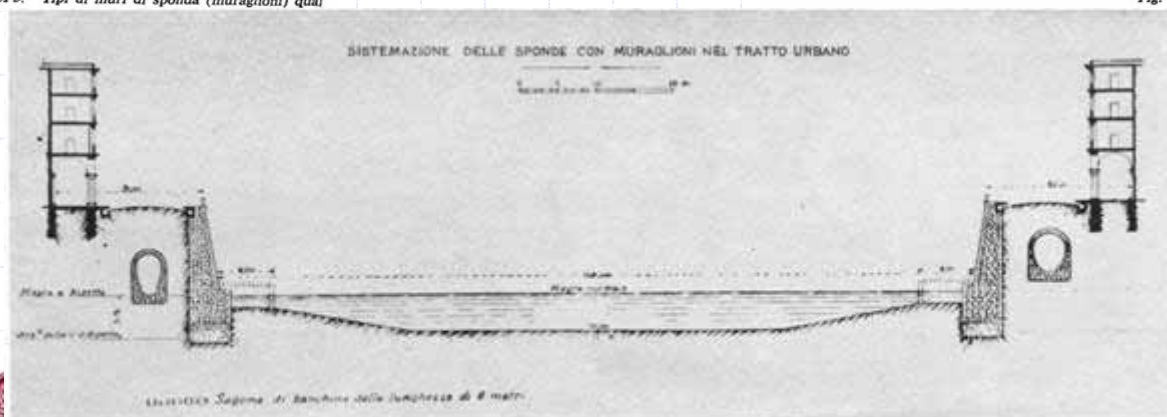
Fig. 52. - Sistemazione delle sponde del Tevere, secondo il progetto Canevari (con le modifiche che vi furono apportate in seguito).
