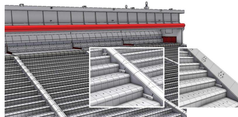
**Estrattore a spintore delle scorie:** scarica le ceneri pesanti e i residui della griglia nei nastri di trasporto scorie verso l'edificio di trattamento scorie, ed è progettato per prevenire l'ingresso di aria nella camera di combustione.
