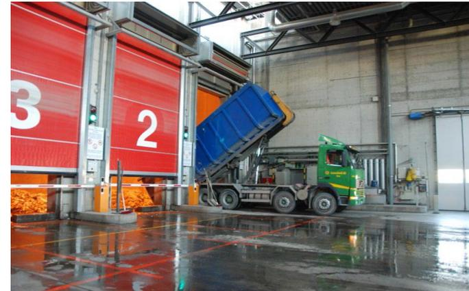
**Fossa:** la fossa ha una capacità di stoccaggio di circa 50.000 mc che, considerando una densità media sull'altezza di stoccaggio pari a 350 kg/mc equivale a c.a. 17.500 t.
